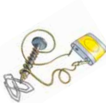
zieht Gegenstände aus Metall an, solange Strom durch die Spule fließt.
