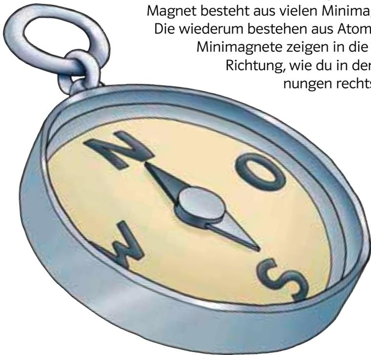
Die Erde hat auch einen magnetischen Nordpol und Südpol. Diese ziehen mit ihrem Magnetismus die Kompassnadeln aus Eisen an. Auch die Kompassnadeln sind kleine Magnete. Die Nadel des Kompasses zeigt immer nach Norden. Mit einem Kompass kannst du die Himmelsrichtung bestimmen. Drehe den Kompass so, dass die Nadel auf das „N“ zeigt. In dieser Richtung ist Norden.
